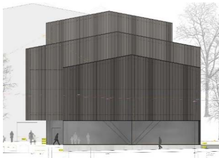
Structure stabilisante en V intégrée en façade Est
